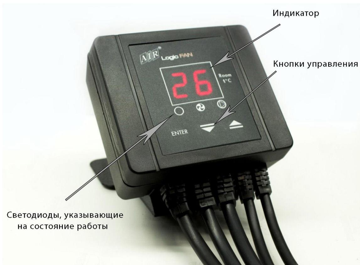
Рисунок 2 – Размещение элементов управления
