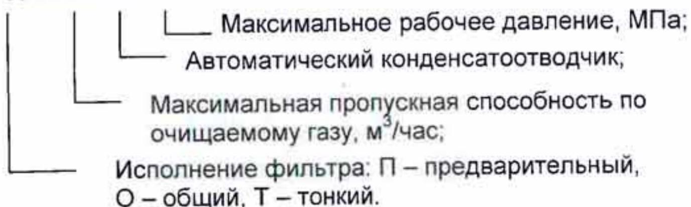
1.6 Фильтры типов ФСВ-П, ФСВ-О, ФСВ-Т комплектуются унифицированными сменными фильтрующими элементами соответственно ЭП, ЭО, ЭТ.
