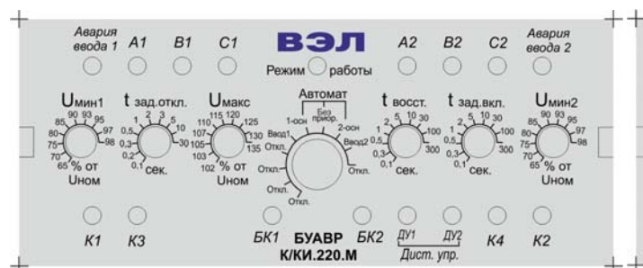
Рис. 3 Расположение органов управления и индикации БУАВР.К и БУАВР.КИ
