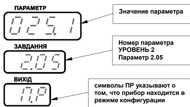
Рисунок 6.3. Индикация значения параметров конфигурации и их номеров.
