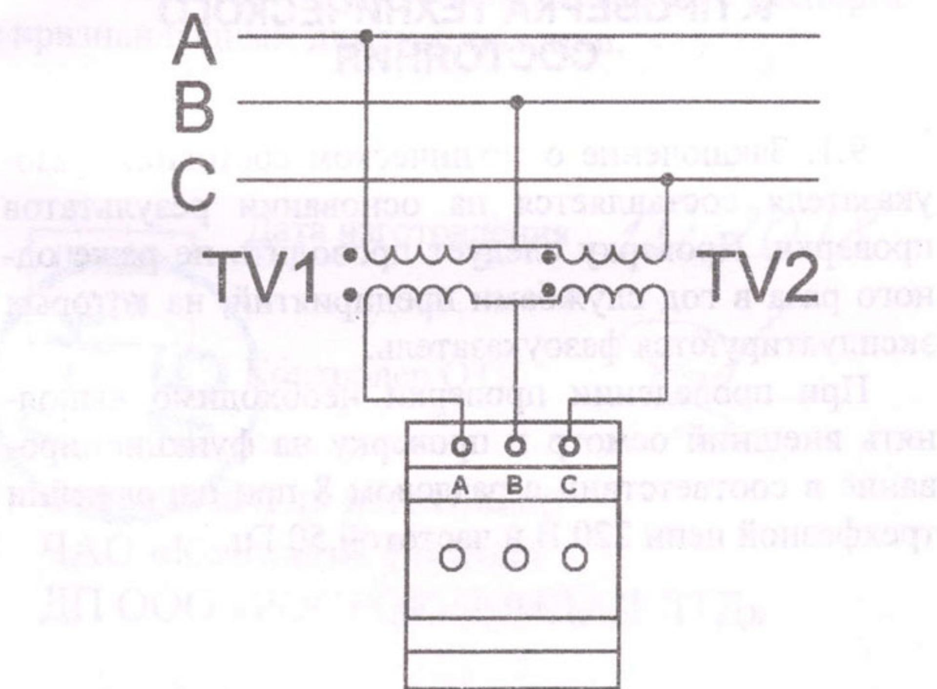
Рис. 8.1 – Схема включения фазоуказателя через однофазные трансформаторы напряжения
