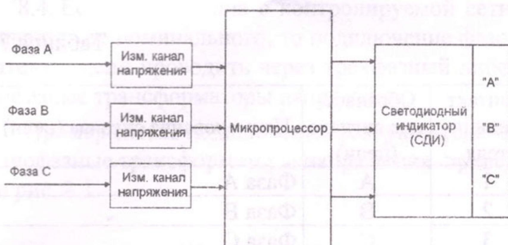
Рис. 6.2 – Структурная схема фазоуказателя
