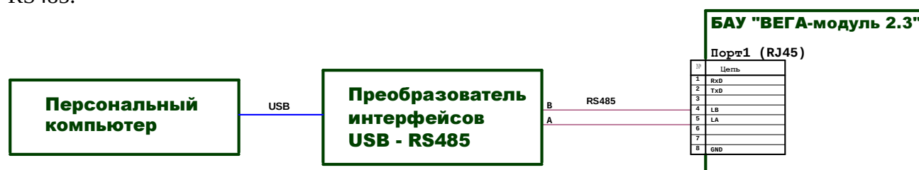
Рис.4. Схема кабеля подключения к БАУ Вега-модуль 2.3 по RS485.
